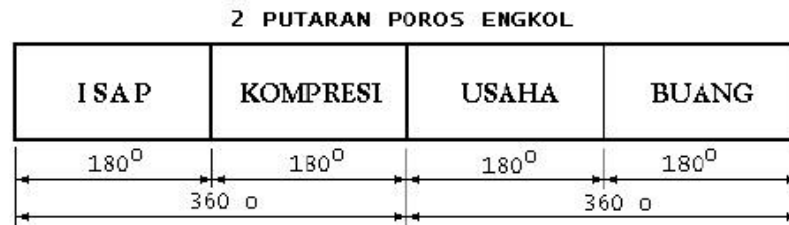
Gambar. 2.1 Proses Kerja Torak (Piston)
