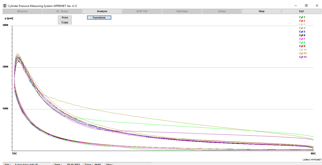
Gambar 4.23. Diagram P/V Menggunakan Bahan Bakar MFO Beban 5 MW Putaran Mesin 500 rpm
