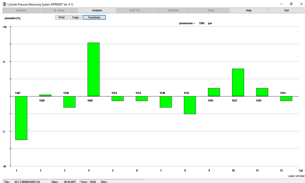
Gambar 4.4. Grafik Pmax Deviation Bahan Bakar HSD Dengan Beban 3 MW Putaran Mesin 500 rpm
