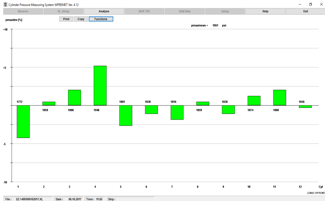
Gambar 4.12. Grafik Pmax Deviation Bahan Bakar HSD Dengan Beban 4 MW Putaran Mesin 500 rpm
