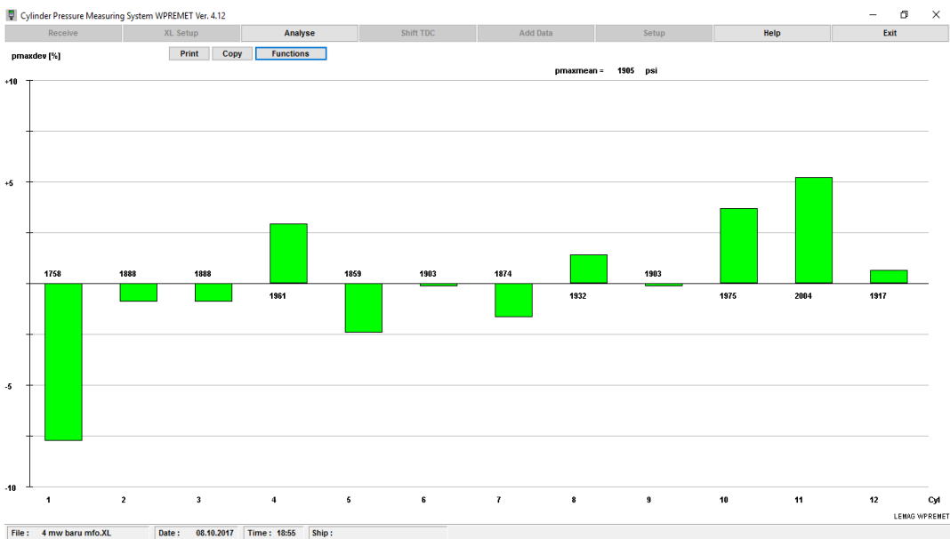
Gambar 4.16. Grafik Pmax Deviation Bahan Bakar MFO Dengan Beban 4 MW Putaran Mesin 500 rpm
