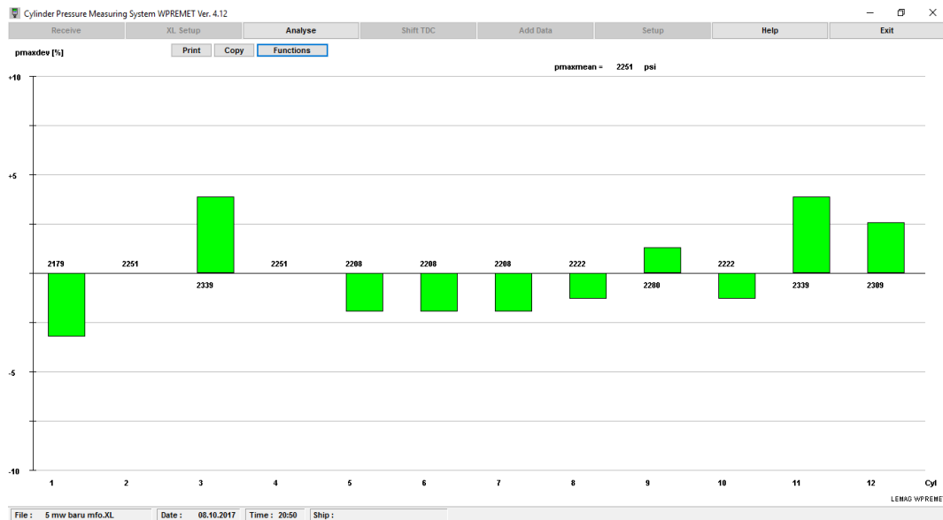
Gambar 4.24 Grafik Pmax Deviation Bahan Bakar MFO Dengan Beban 5 MW Putaran Mesin 500 rpm
