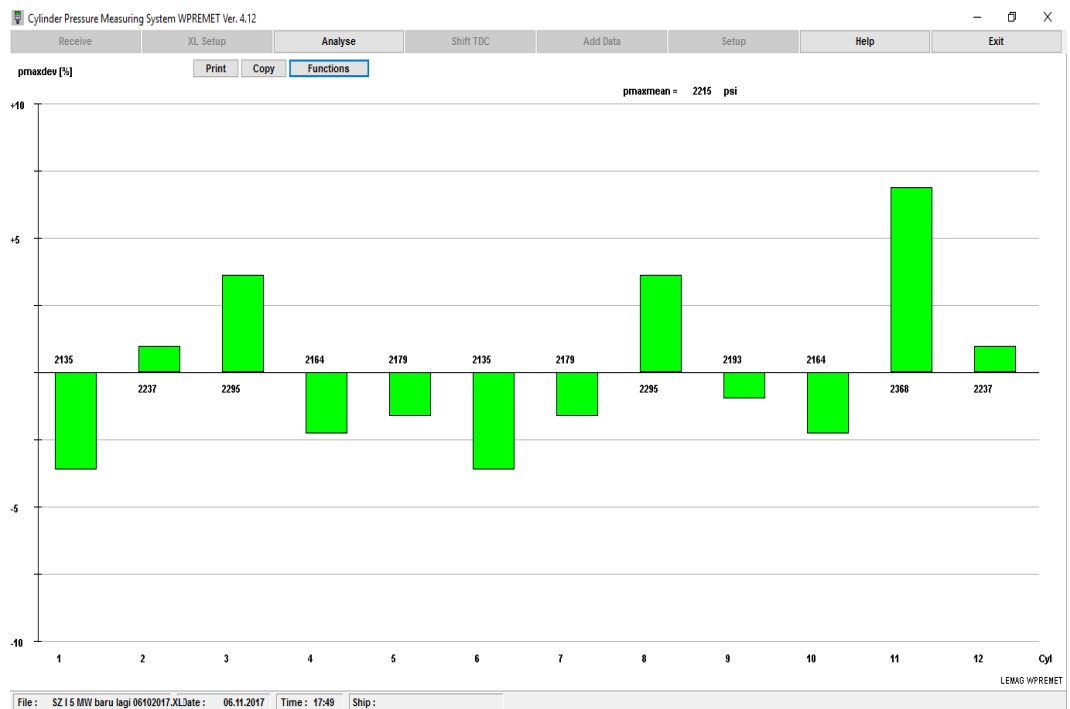
Gambar 4.20. Grafik Pmax Deviation Bahan Bakar HSD Dengan Beban 5 MW Putaran Mesin 500 rpm
