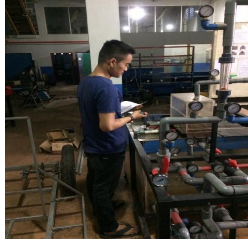
Melihat Putaran RPM Melalui Tachometer Yang Dihasilkan Putaran Turbin Pelton.
