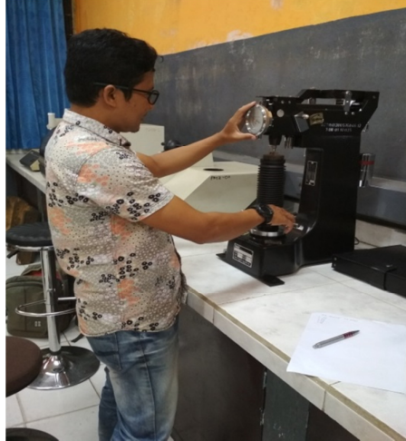
Gambar 3.4 pengujian kekerasan dengan Rockwell F
