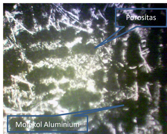
Gambar 4.4. Struktur Micro Pada Pembesaran 200 kali pada pengecoran bahan Piston bekas
