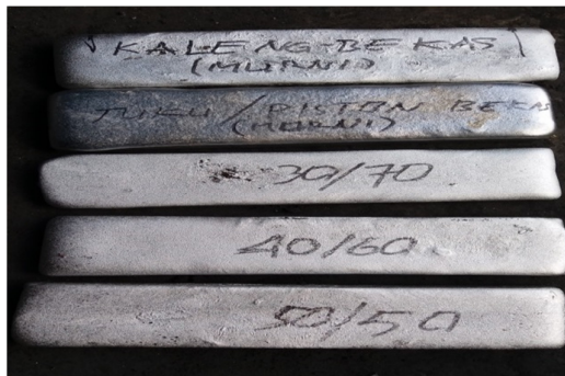
Gambar 3.1. hasil pengecoran kaleng bekas, piston bekas, campuran 30/70, campuran 40/60, dan campuran 50/50
