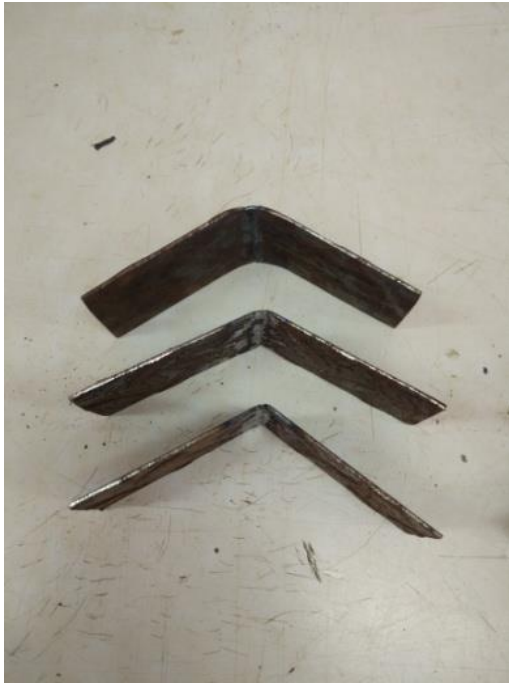
Plat stelah pengujian lengkung las listrik
