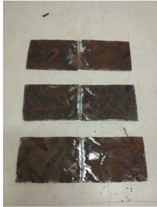
Plat setelah pengujian tarik las listrik
