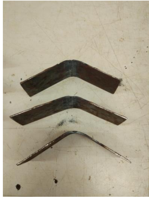
Plat stelah pengujian lengkung las asetilin
