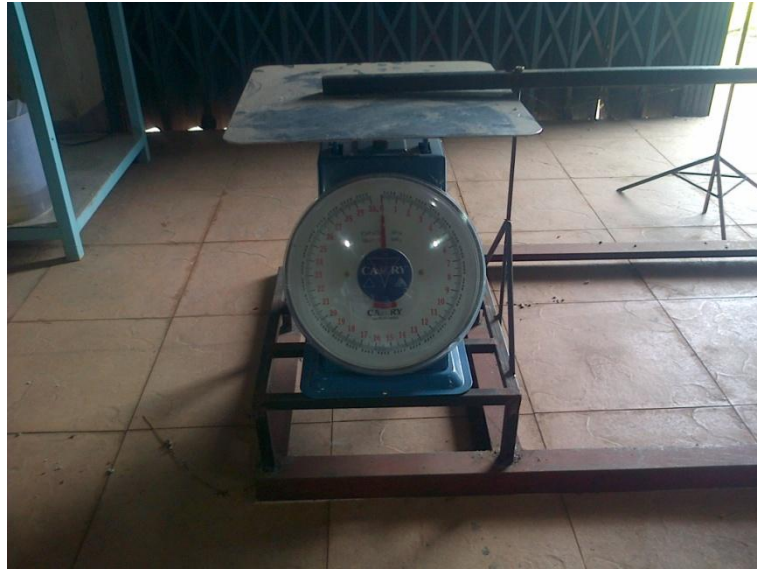
Gambar 3.3.3 Timbangan pengukur gaya tekan
