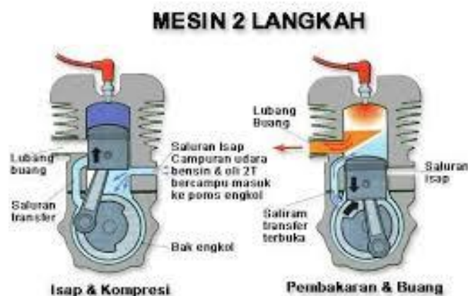
Gambar 2.4.2 Langkah Gerakan Torak 2 Langkah (Sumber : Motor Bakar,2014)
