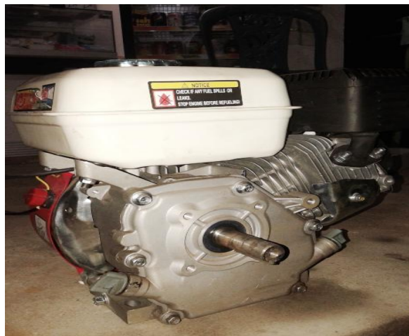
Gambar 3.3.2 mesin matari satu silinder lokasi di Universitas Muhammadiyah Pontianak
