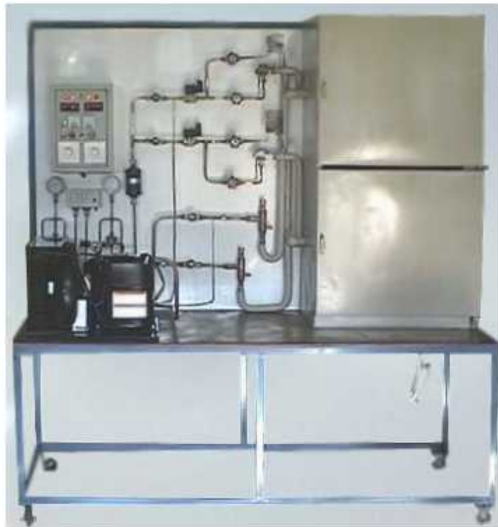
Gambar 3. Mesin refrigerasi kompresi uap dengan 2 evaporator
