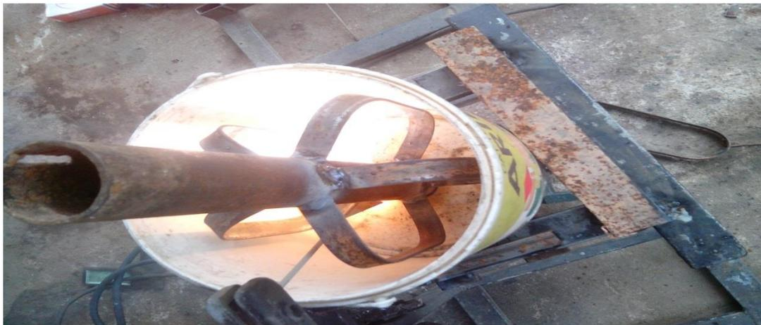
*Gambar 2. Cetakan cor untuk pembuatan tapak ban*
