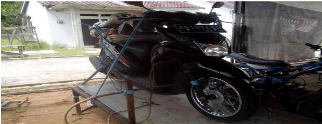
*Gambar 21. Pengujian dengan beban 223Kg*
