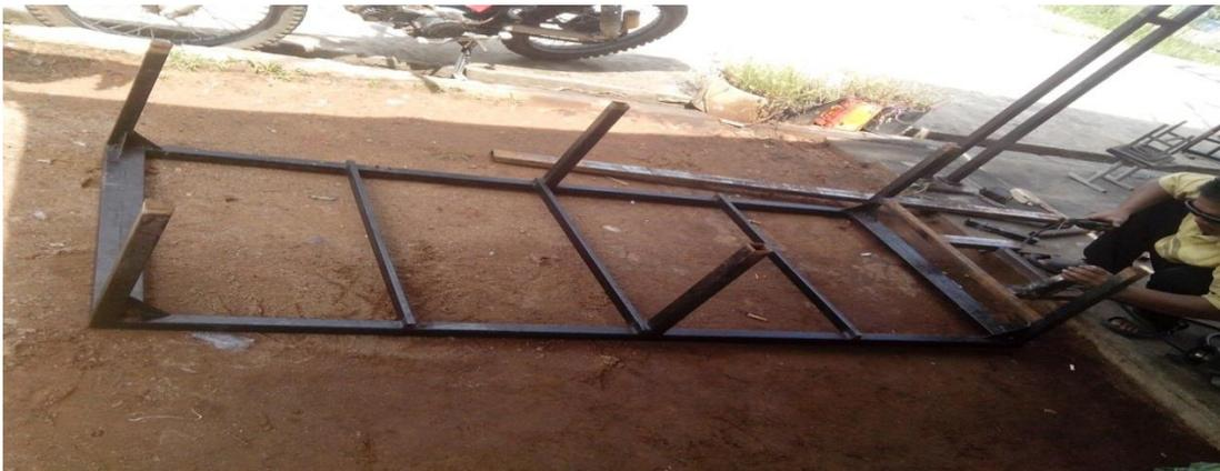
*Gambar 5. Pembuatan meja untuk dudukan motor*
