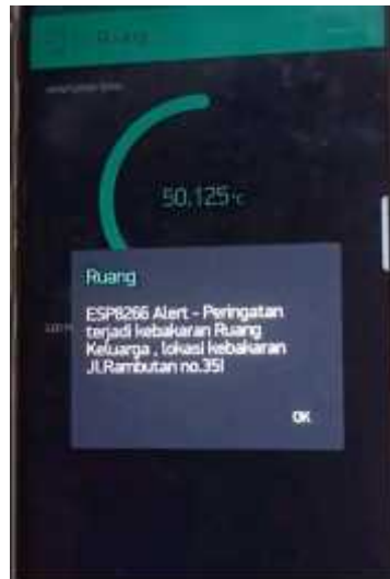
Gambar 8.5 Tampilan Blynk sensor api dan sensor suhu terdeteksi
