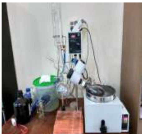
Gambar 5.5. Di evaporasi menggunakan rotary evaporator.
