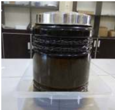
Gambar 5.3. Perendaman serbuk daun mengkudu menggunakan etanol.
