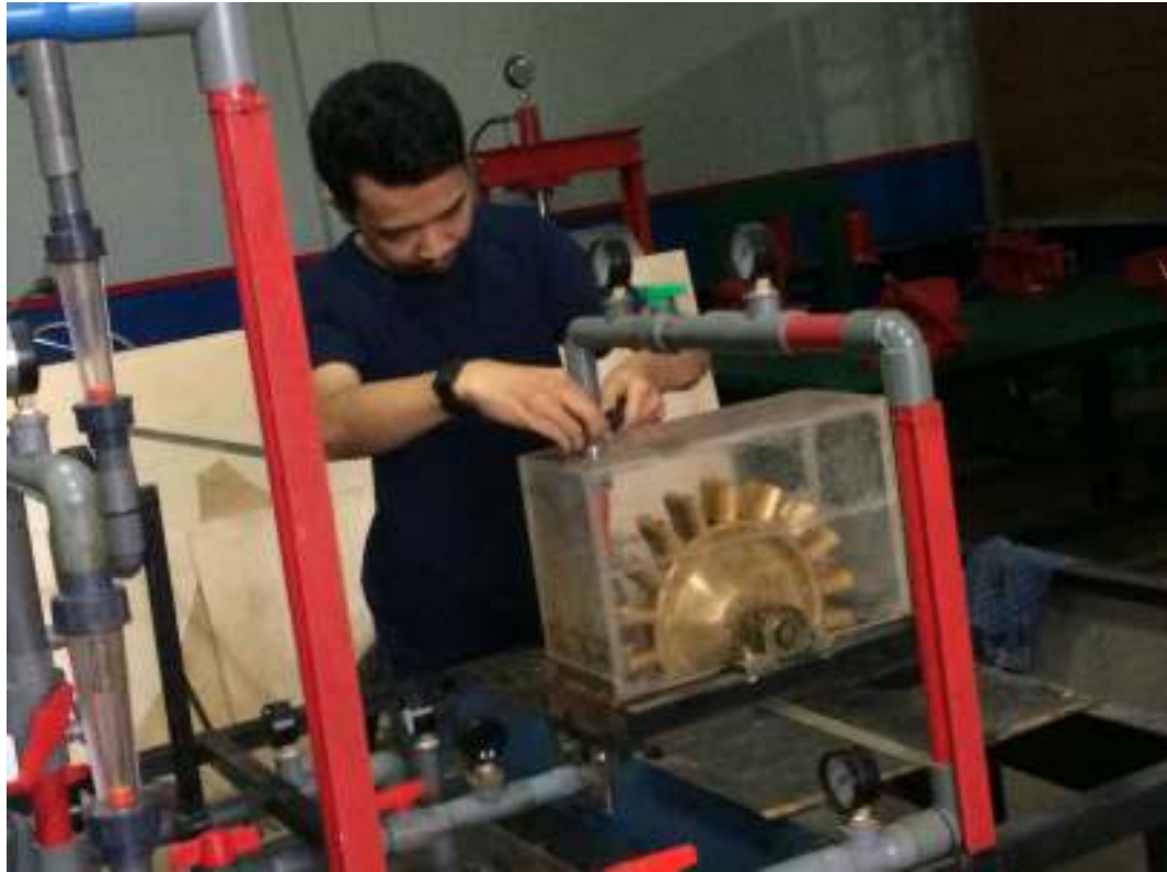
Lampiran 3 Pemasangan Nozzle Pada Turbin
