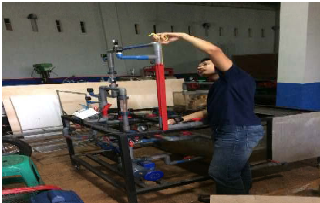
Lampiran 2 Pengukuran Panjang Pipa
