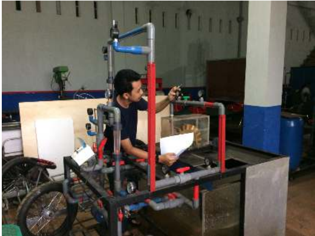
Lampira 5 Pengambilan Data Tekanan Pada Turbin
