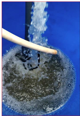
Proses Aerasi selama 1 jam dan sedimentasi 2 jam
