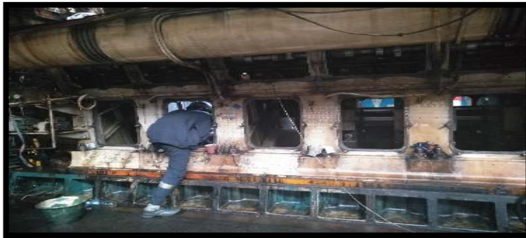
Gambar V.3 Mesin PLTD Merk Sulzer Tipe 12 ZAV 40S
