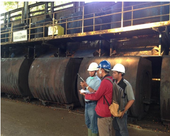
Pengukuran Kebisingan di Area Loading Ramp
