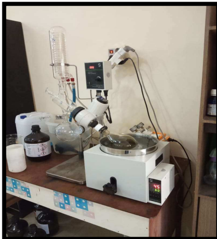
Gambar 5.7. Di evaporasi menggunakan rotary evaporator.
