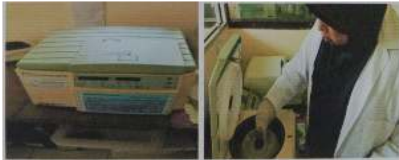
Sentrifuge untuk memisahkan pellet dan supernatant atau untuk memperoleh butiran / pellet DNA
