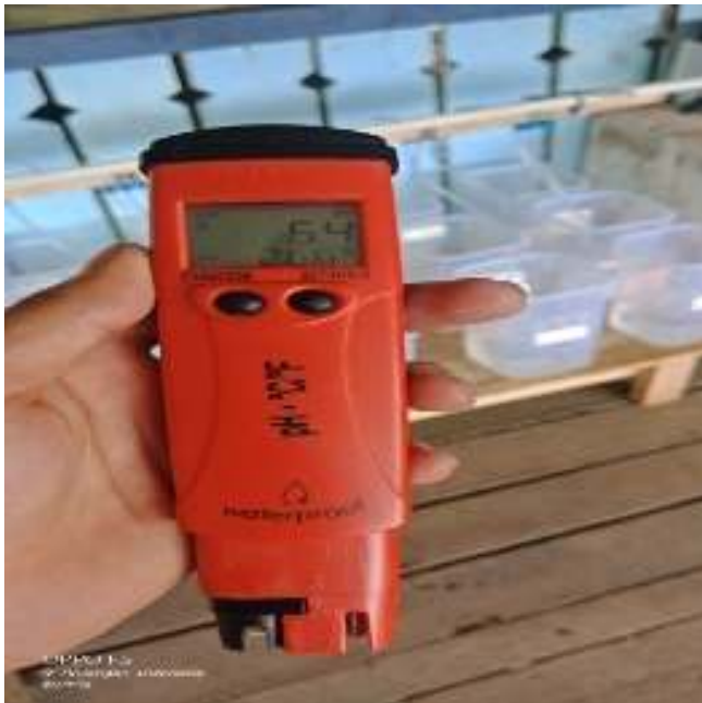
Gambar 14. pH Meter, Bisa Ukur pH dan Suhu Secara Digital
