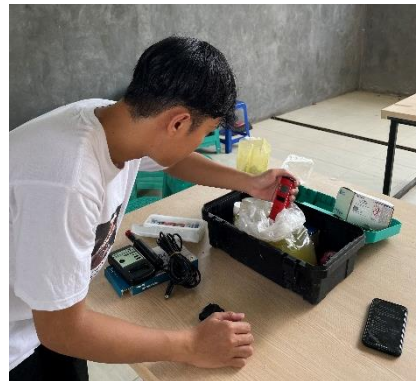
Pengukuran suhu dan pH media pengangkutan
