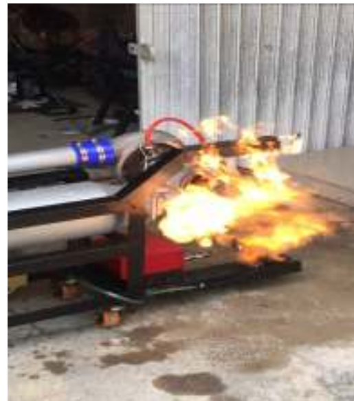
Pembakaran yang terjadi pada sistem MGT belum sempurna
