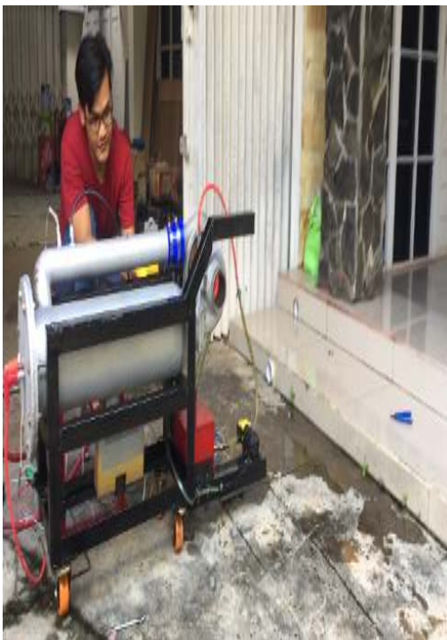
Pembakaran yang terjadi pada sistem MGT belum sempurna
