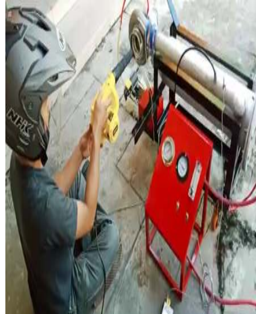
Proses Starting pada sistem MGT menggunakan blower
