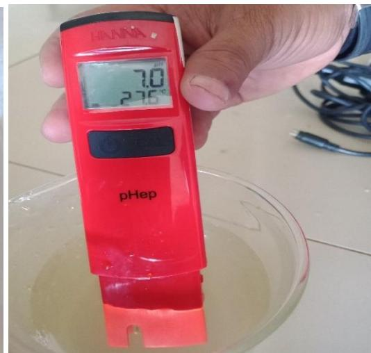
Gambar 16. Pengukuran pH
