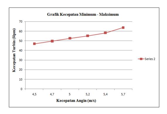
Grafik 4.1 menunjukkan bahwa semakin besar kecepatan angin maka semakin besar pula kecepatan turbin yang dihasilkan. Dengan menggunakan kipas angin kecepatan turbin dengan jarak 1 meter maka dihasilkan minimum 46.9 rpm dengan kecepatan angin 4.5 m/s sedangkan kecepatan turbin maksimum 63.8 rpm dengan kecepatan angin 5.7 m/s.
