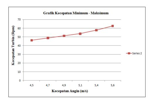
Grafik 4.3 menunjukkan bahwa semakin besar kecepatan angin maka semakin besar pula kecepatan turbin yang dihasilkan. Dengan menggunakan kipas angin kecepatan turbin dengan jarak 1 meter maka dihasilkan minimum 46.2 rpm dengan kecepatan angin 4.5 m/s sedangkan kecepatan turbin maksimum 62.6 rpm dengan kecepatan angin 5.6 m/s.
