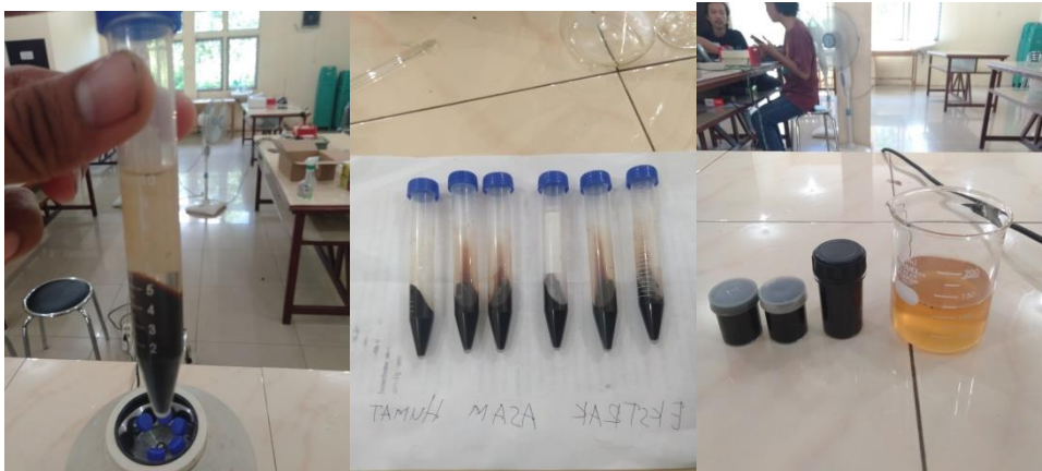
Hasil endapan setelah di campur asam kuat 6 M HCL
